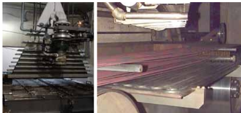
Figura 1. Acelerador de elétrons e o processo de irradiação de fios e cabos.
