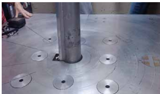
Figura 5. Mesa de exposição localizada acima da fonte panorâmica de CO 60 , as marcações na mesa servem como referencial para estimar a dose no produto.
